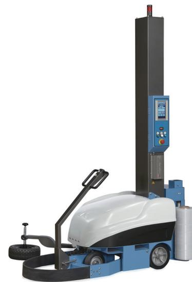
タッチセンサーが包装物を検知して、大きな対象物も自動で周囲を走行し、ラッピング作業をします。
