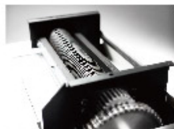
一体加工・熱処理されたカッター ローラーは長期間にわたる加工に 耐えます。
